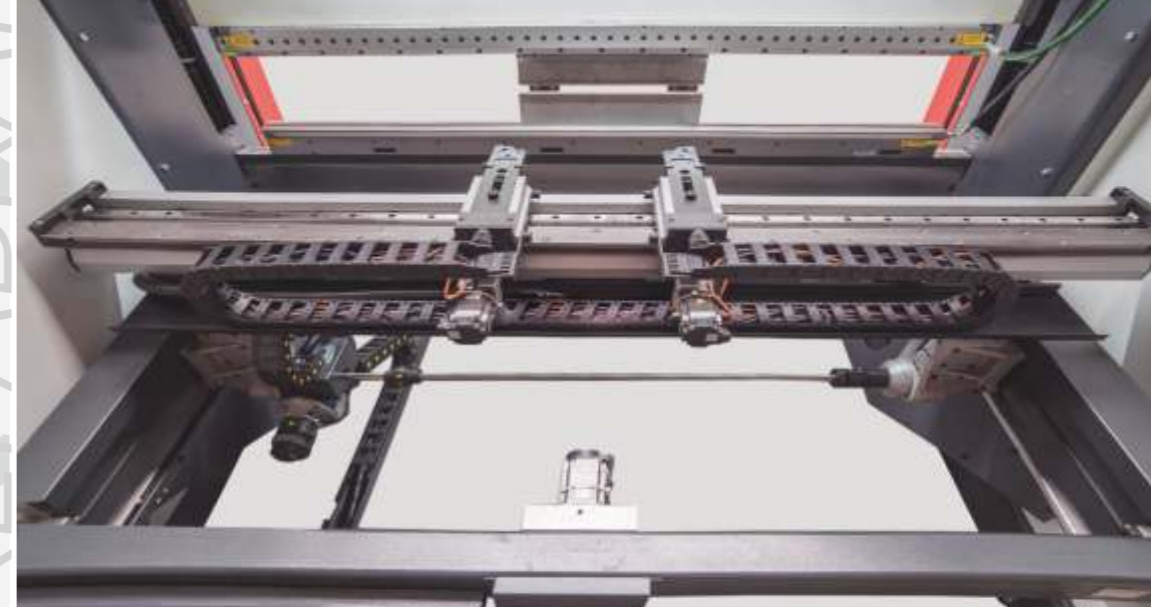
X - R - Z1 - Z2 4 Eksen Arka Dayama Opsiyonu
