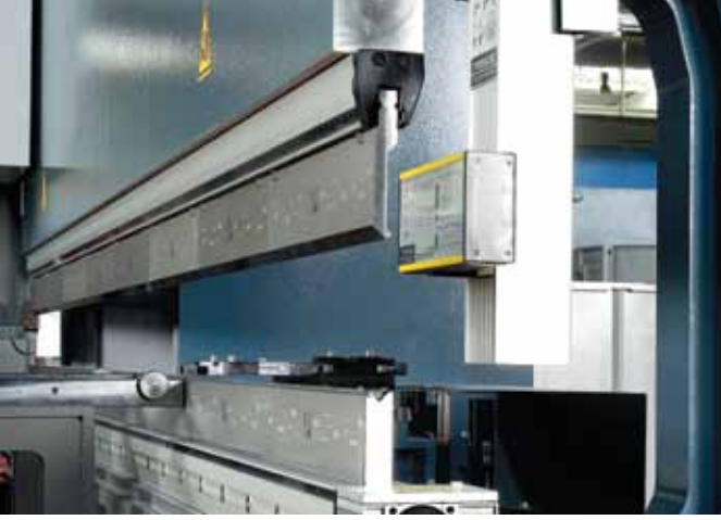
Hidrolik Yeni Standart Sıkma Sistemi
