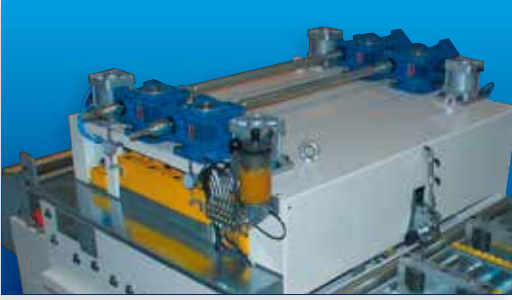
Sonsuz Vida - Dişli Boşluk Ayarı Worm Screw and Worm Gear Gap Adjustment
