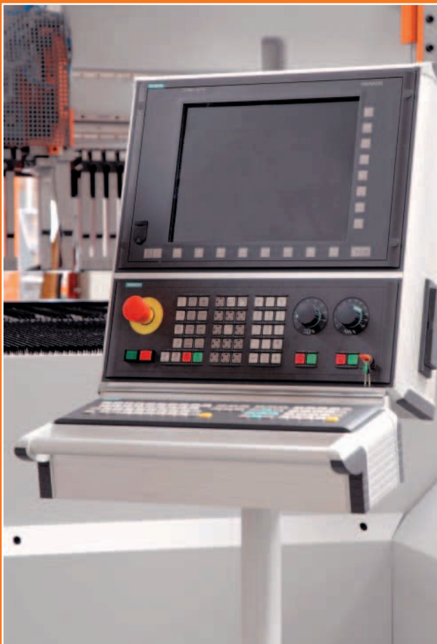
CNC control unit Siemens SINUMERIK 840D
