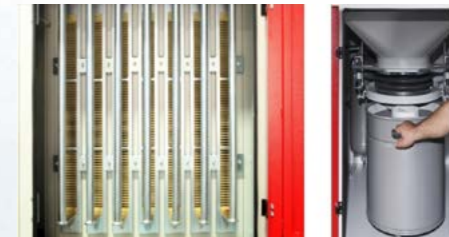
Filtreler ve toz kovası mekanizmasına kolay erişim
