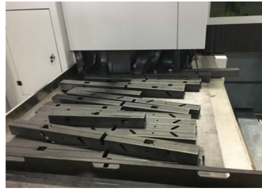
Konveyörlü otomatik boşaltma sistemi ile 6m uzunluğa kadar boru ve profiller tahliye edilir.
