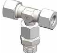
ORTA BACAK RAKORLU T - ORT/BSP 1/8" - 6 mm ..... 1 1/2" - 42 mm arası
