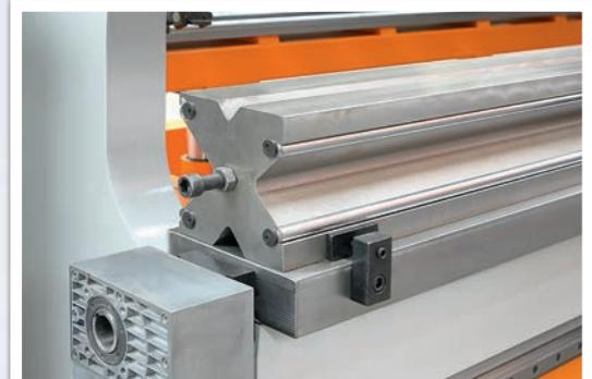
**STANDARD BACKGAUGE REST AXES**
